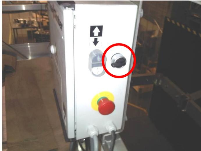
Image 1 Commutateur de sélection pour commande mobile
