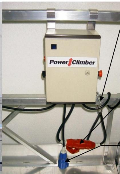
Le treuil TITAN est un treuil à amorçage automatique du câble, mué par un moteur électrique. Le treuil et le coffret de commande (CC) sont monté sur des Plates-formes Suspendues Temporaires (PST), qui sont suspendues par des câbles acier accrochés à un système de suspension. La plate-forme et le système de suspension utilisé en combinaison avec le treuil TITAN doivent être compatibles avec la Charge Maximale d'Utilisation (WLL) des treuils.
