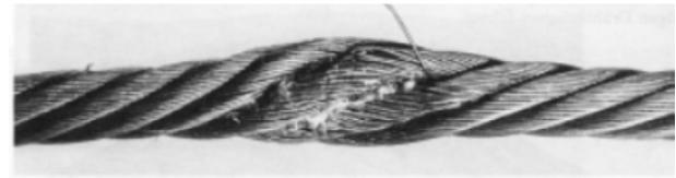
Abbildung 10: Drahtseil mit Abplattung, entstanden durch Überfahren
